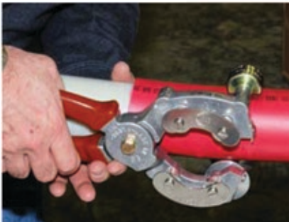
Longitudinal Jacket Cut
